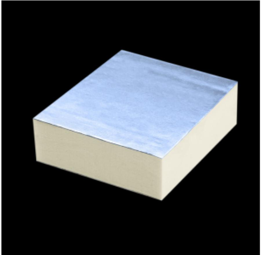
**EI POLIISO® AIR CARE GA080** es un panel sándwich formado por una espuma rígida de poliiso (espuma de poliuretano) de célula cerrada de color amarillo expandida entre dos soportes de aluminio: el de la cara exterior de aluminio gofrado de 80  $\mu\text{m}$  y el de la cara interior de aluminio liso antibacteriano de 80  $\mu\text{m}$ .
