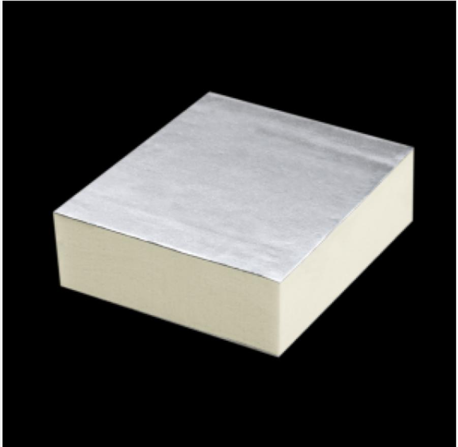
**EI POLIISO® AIR INDOOR GL200** es un panel sándwich formado por espuma rígida de poliiso (espuma de poliuretano) de célula cerrada de color amarillo expandida entre dos soportes de aluminio: el de la cara exterior de aluminio gofrado de 80  $\mu\text{m}$  y el de la cara interior de aluminio liso de 200  $\mu\text{m}$ .
