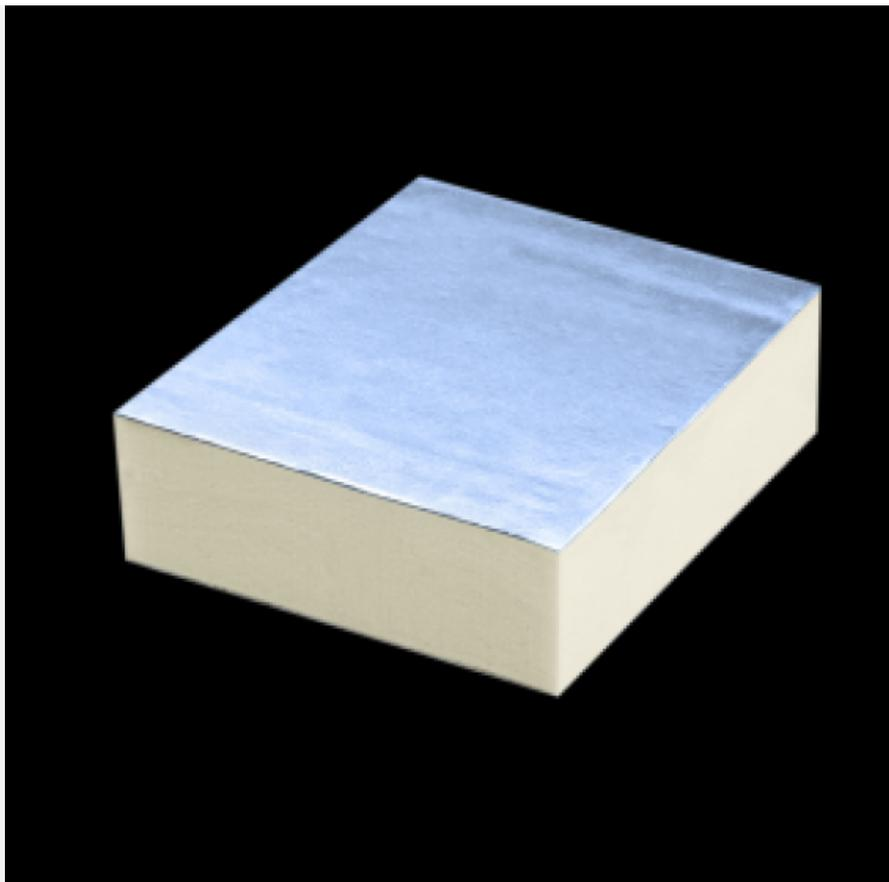
**POLIISO® AIR CARE GA080** est un panneau sandwich constitué d'une mousse rigide de polyiso (mousse de polyuréthane) à cellules fermées, de couleur jaune, expansée entre deux supports en aluminium : celui de la face extérieure en aluminium gaufré de 80 µm et celui de la face intérieure en aluminium lisse antibactérien de 80 µm.
