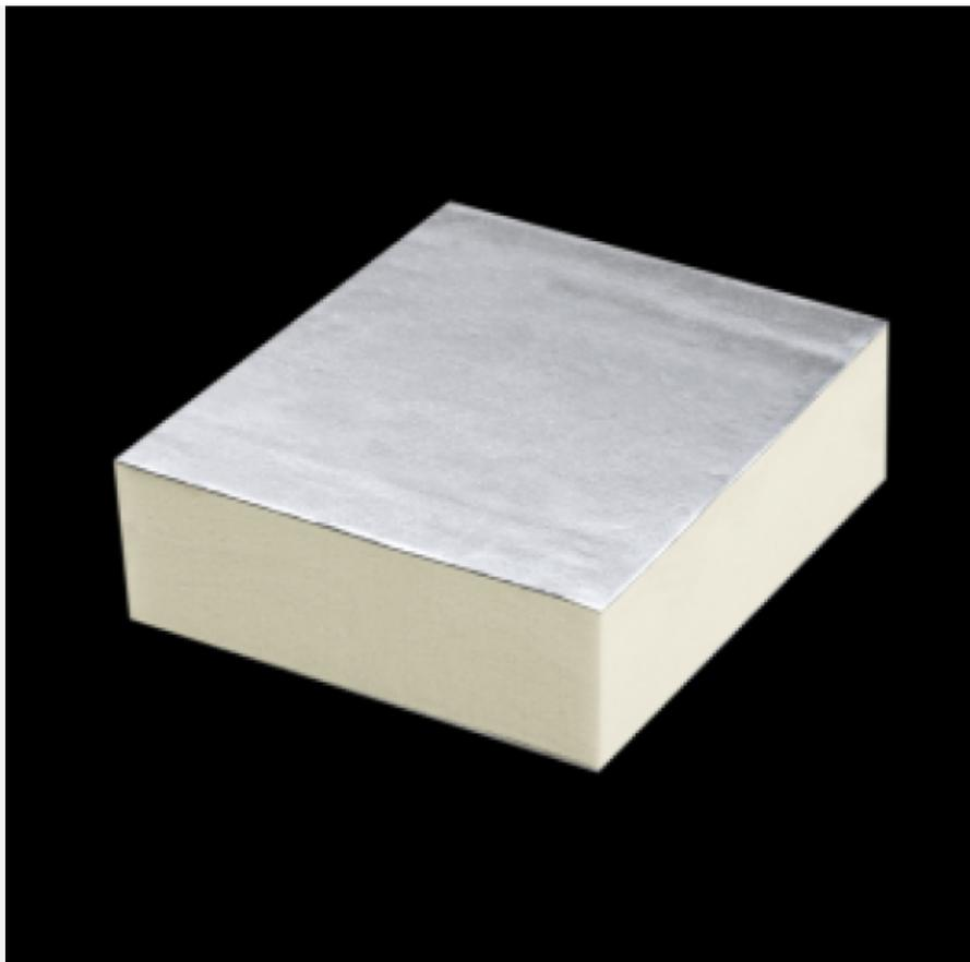
**POLIISO® AIR OUTDOOR GL400** est un panneau sandwich composé d'une mousse polyiso (mousse de polyuréthane) rigide à cellules fermées de couleur jaune, expansée entre deux supports en aluminium : la face extérieure en aluminium gaufré de 200 µm et la face intérieure en aluminium lisse de 200 µm.
