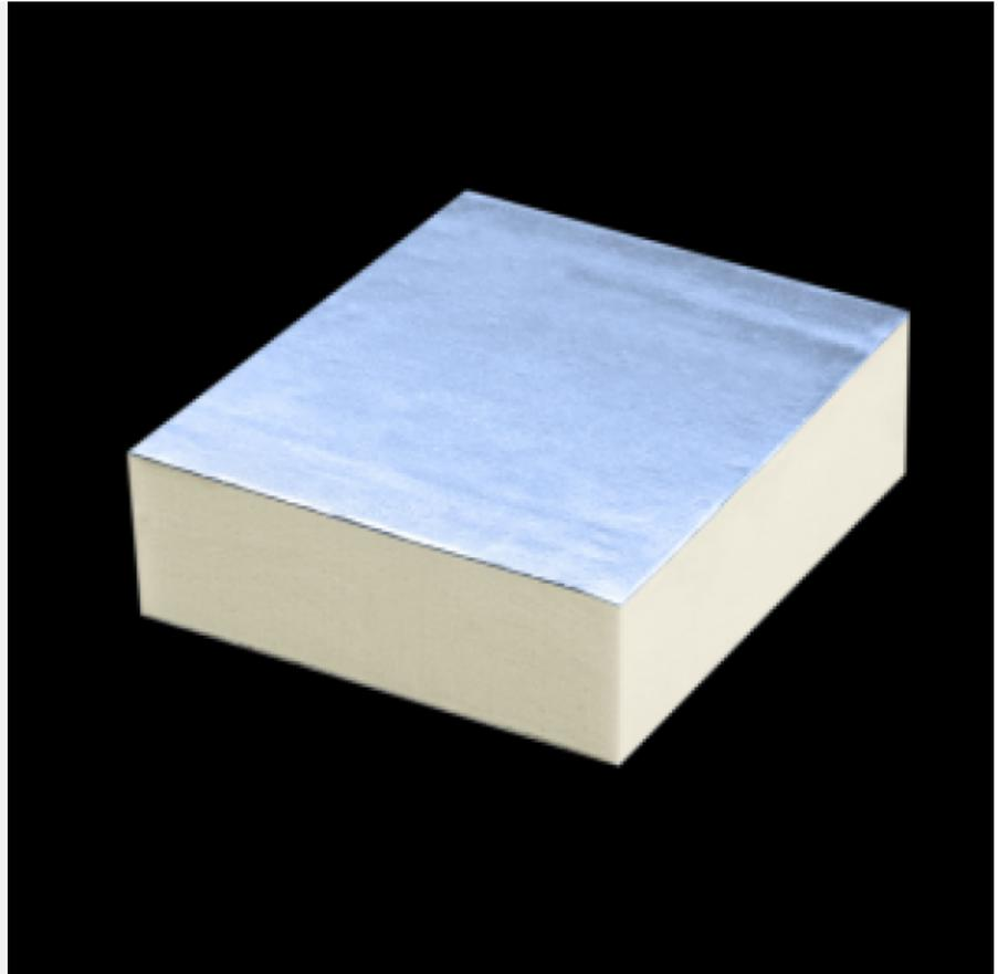
**POLIISO® AIR CARE AG200** è un pannello sandwich costituito da una schiuma polyiso (poliuretano espanso) rigida a celle chiuse, di colore giallo, espansa fra due supporti di alluminio: quello della faccia esterna in alluminio goffrato da 200  $\mu\text{m}$  e quello della faccia interna in alluminio liscio antibatterico da 80  $\mu\text{m}$ .
