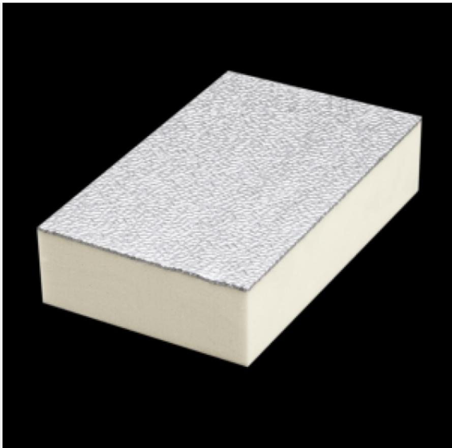
**POLIISO® AIR INDOOR GG060** è un pannello sandwich costituito da una schiuma polyiso (poliuretano espanso) rigida a celle chiuse, di colore giallo, espansa fra due supporti di alluminio gofrato da 60 µm.
