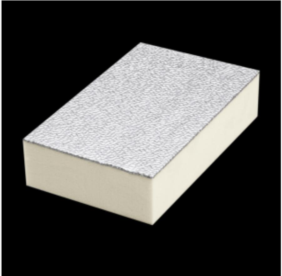
**POLIISO® AIR INDOOR GG080** è un pannello sandwich costituito da una schiuma polyiso (poliuretano espanso) rigida a celle chiuse, di colore giallo, espansa fra due supporti di alluminio goffrato da 80 µm.
